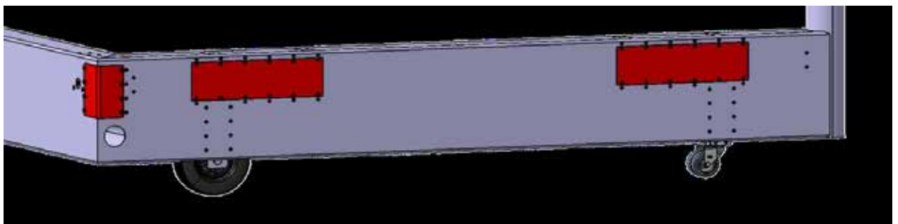
Abb. 23: Klappen zur Montage des Mechanismus im seitlichen Bodenrahmen (Brosius et al., 2020)
