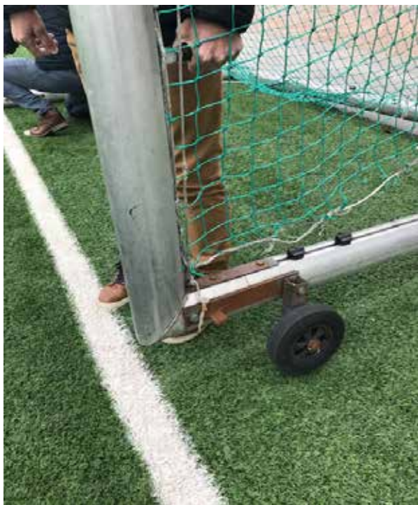
Abb. 15: Hebelkonstruktion zum Transport (Quelle: Matthias Eiles)
