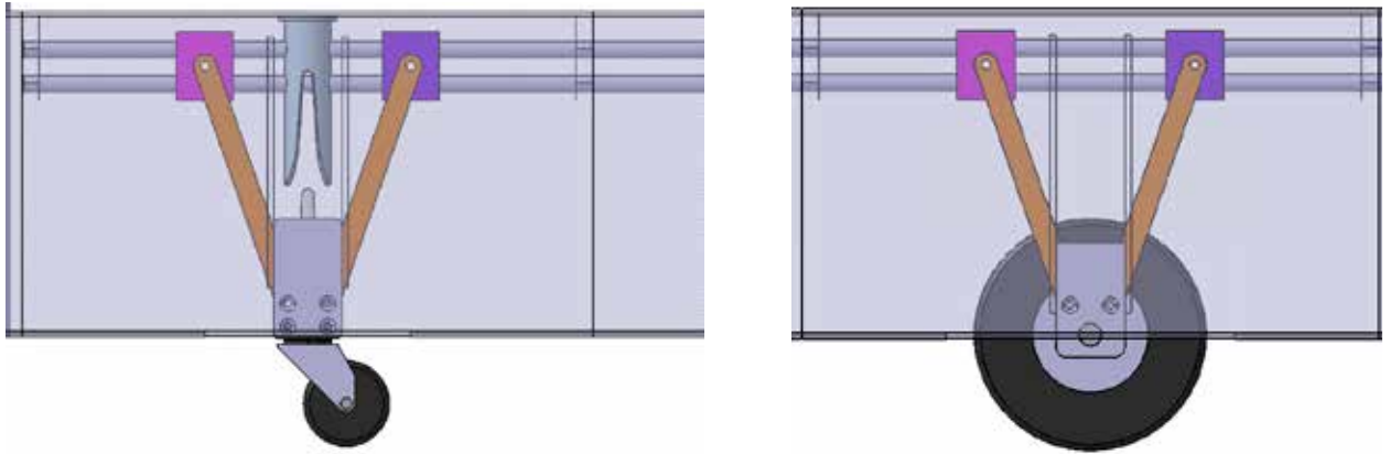
Abb. 22: Scherensystem der beiden Räder im seitlichen Bodenrahmen (Boberg, Kötting, 2019)
