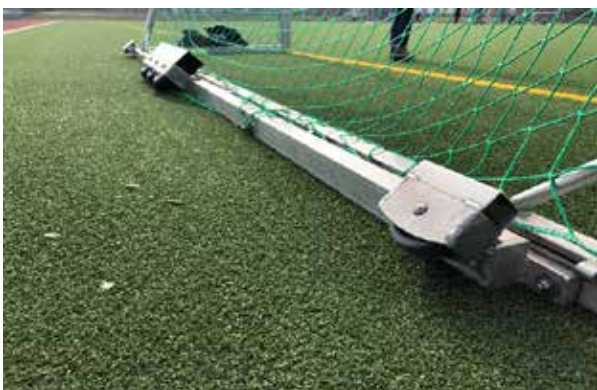
Abb. 4: Nachträglich montiertes Gewicht
