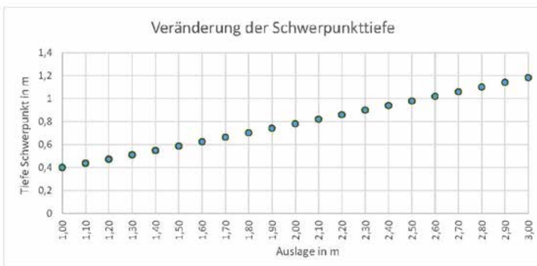
Abb. 12: Veränderung der Schwerpunkttiefe je nach Auslage eines 7,32 x 2,44 m Tors
